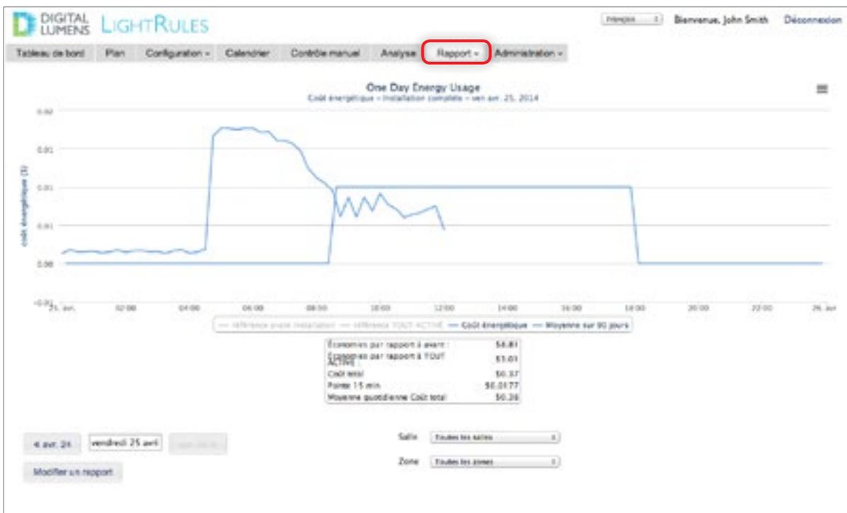
LightRules 2.11 présente une fonction d'analyse *par simulation*, permettant d'estimer les économies d'énergie pouvant être réalisées grâce à l'utilisation de paramètres différents au sein d'une zone, d'une salle, ou de l'installation toute entière. L'analyse par simulation utilise des données réelles enregistrées pour générer des prévisions.
